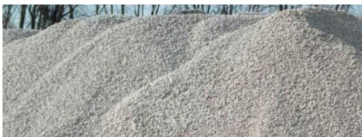
*Slika 2 – Agregat za beton [36]*
