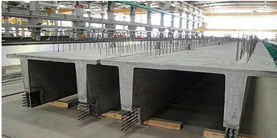
Slika 9 – Prefabricirane prednapregnute  $\Pi$  – ploče [33]
